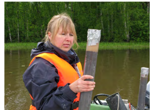
Kuva 2. Sedimenttinäytteenottoa Hiidenveden Kirkkojärvellä. Vasemmalla näytteenotin, Uwitec-paino-voimakaira, ja oikealla järven pohjasta nostetut sedimenttisarjat. Kuva: Marjut Kaukolehto.
