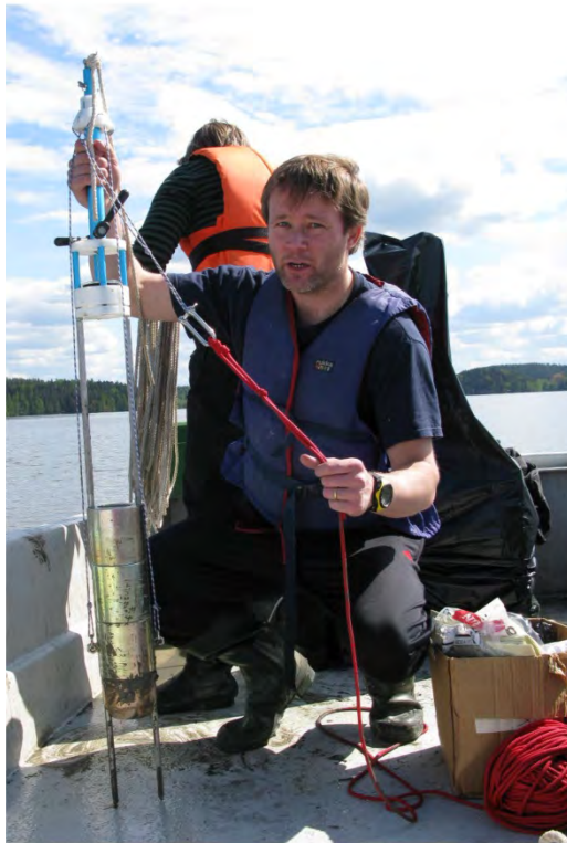
Kuva 2. Sedimenttinäytteenottoa Hiidenveden Kirkkojärvellä. Vasemmalla näytteenotin, Uwitec-paino-voimakaira, ja oikealla järven pohjasta nostetut sedimenttisarjat. Kuva: Marjut Kaukolehto.
