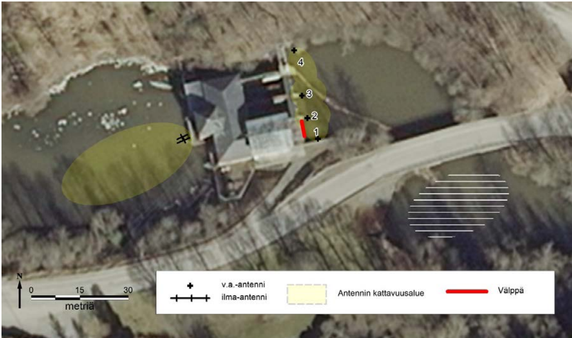
Kuva 10. Åminneforsin voimalaitospadolle asennettujen antennien sijoittuminen ja niiden arvioitut pääasialliset kattavuusalueet. Lisäksi karttaan on merkitty alue, jossa lähes kaikki padolle saapuvista kaloista pysähtyivät ennen voimalaitokselle saapumista (vaakaviivoitettu alue) (sisältää Maanmittauslaitoksen Ilmakuvatietokannan 06/2017 aineistoa).
