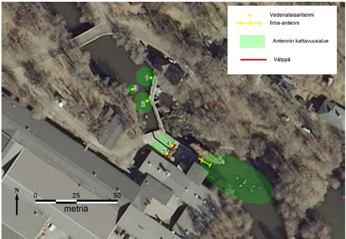
Kuva 4. Mustionkosken voimalaitospadolle asennettujen antennien sijoittuminen ja niiden arvioidut pääasialliset kattavuusalueet (sisältää Maanmittauslaitoksen Ilmakuvatietokannan 06/2017 aineistoa).
