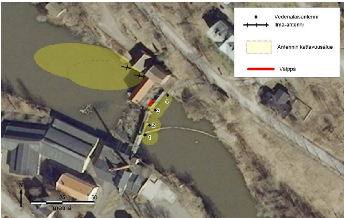
Kuva 8. Billnäsin voimalaitospadolle asennettujen antennien sijoittuminen ja niiden arvioidut pääasialliset kattavuusalueet (sisältää Maanmittauslaitoksen Ilmakuvatietokannan 06/2017 aineistoa).
